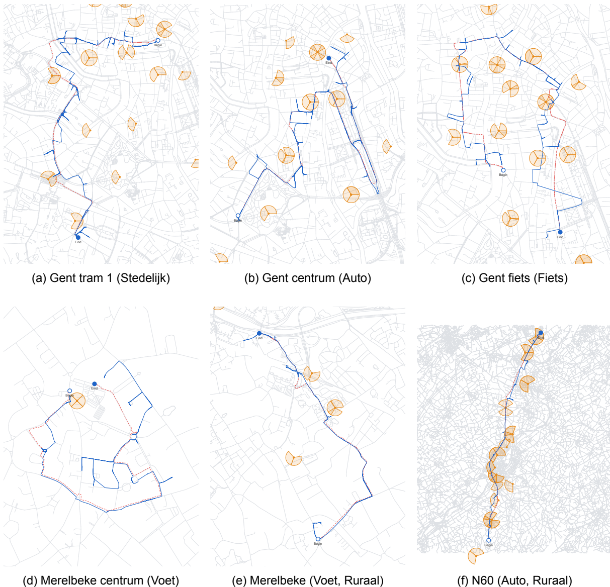
Figure 5.4: Visualisatie van zes representatieve trajecten in verschillende omgevingen. De blauwe lijn toont het geschatte Viterbi-pad, de grijze stippellijn het GPS ground truth traject.
