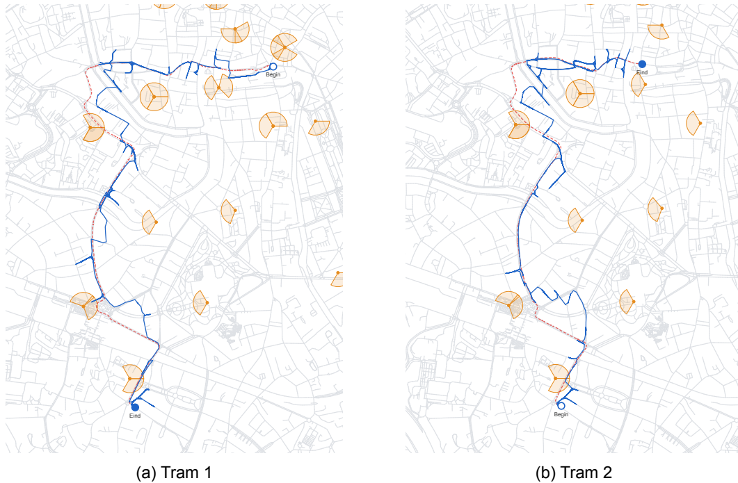
Figure 5.7: Visualisatie van de twee tramtrajecten over dezelfde route. Blauw: Viterbi-schatting, rood gestippeld: GPS.
